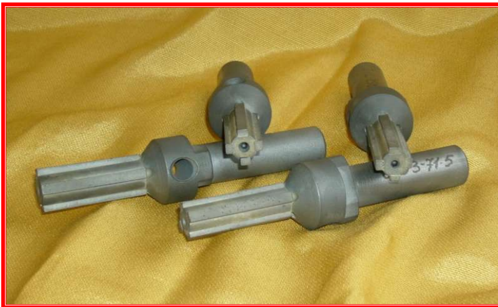
Фрезы \Phi 16 мм, оснащенные алмазно-твердосплавными пластинами 40x3x4 мм.
