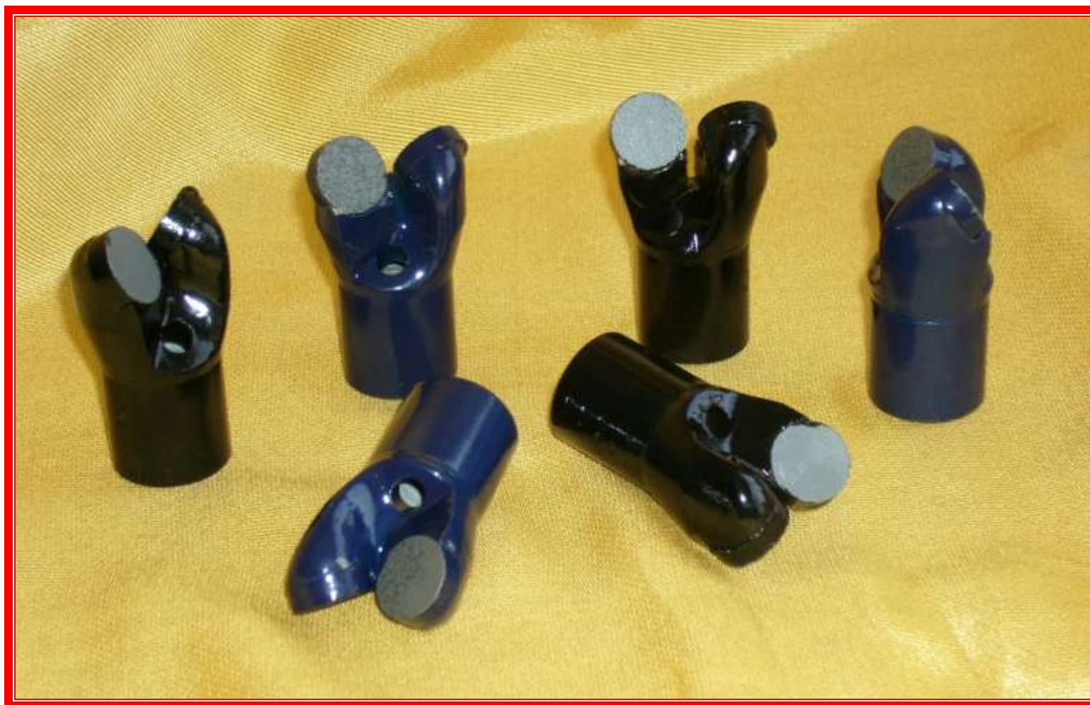
Буровые резцы Ф32, оснащенные алмазно-твердосплавными пластинами Ф13х4 мм.
