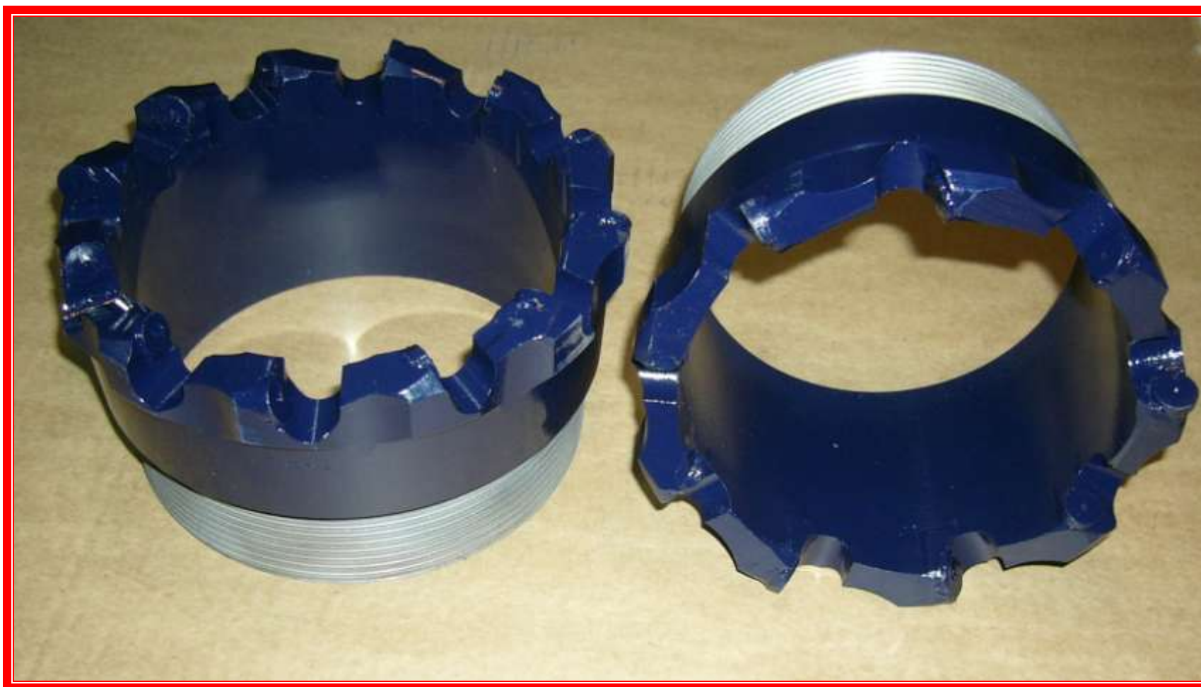
Буровые долота \Phi 150 мм, оснащенные алмазно-твердосплавными пластинами \Phi 13 \times 4 мм.
